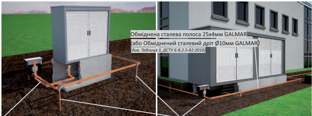
Обміднена сталева полоса 25x4мм GALMAR (або Обміднений сталевий дріт Ø8мм GALMAR) (див. Таблиця 3, ДСТУ Б В.2.5-82:2016)
